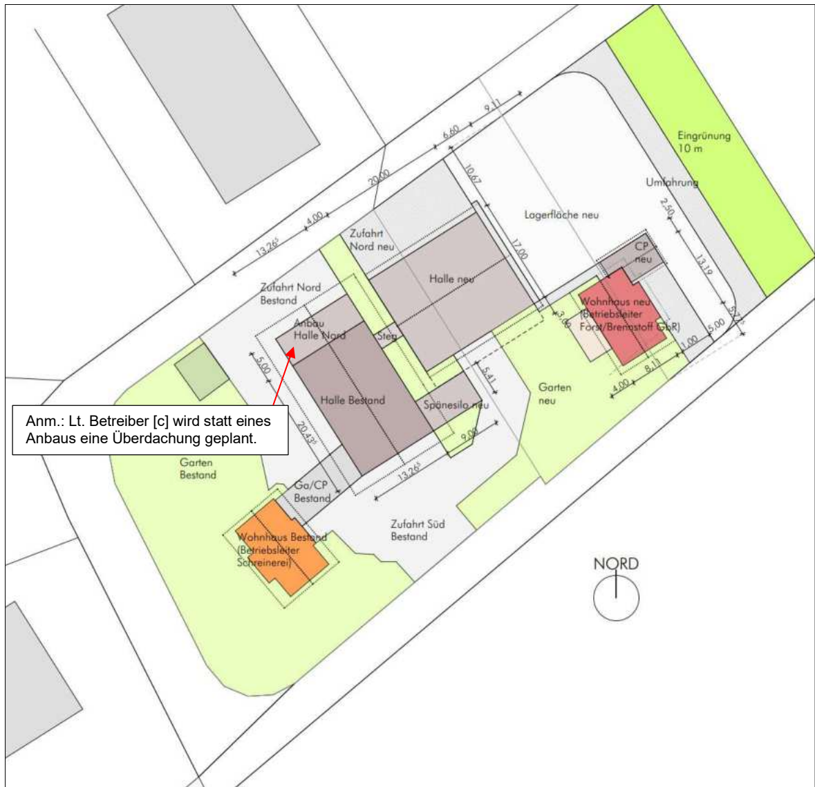
Abb. 6: Vorabzug Vorhaben-/Erschließungsplan mit Bestand und geplanten (Bau-)Maßnahmen gemäß [a] (Verfasser: abtplan - architektur & stadtplanung)
