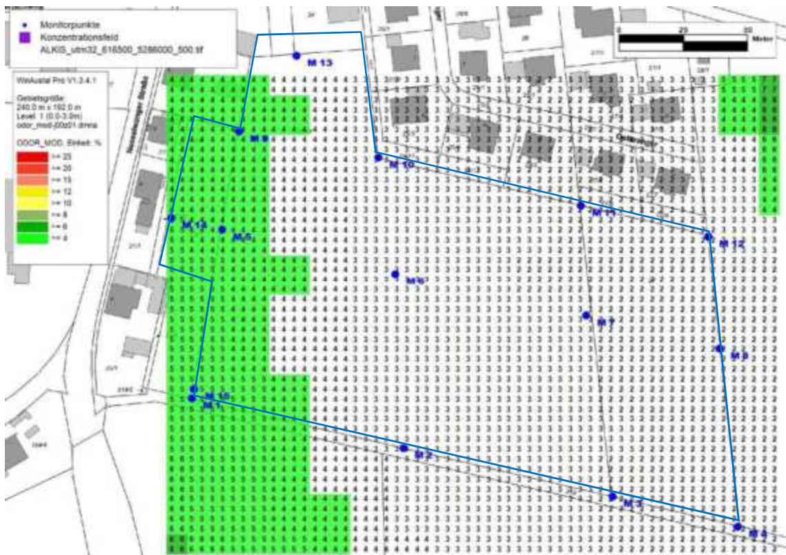
Abbildung 7: Geruchshäufigkeiten pro Jahr in % im Baugebiet Wald, Ausbreitungsrechnung mit standortbezogener synthetischer AKTerm, Monitorpunkte und Umgriff Baugebiet (blau), Auswertung mit Netz 1, Quelle Karte: Bayerische Vermessungsverwaltung
